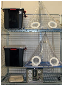
Abb. 3: Versuchsaufbau der Zelte und Boxen, in denen die Pilze gelagert wurden.
